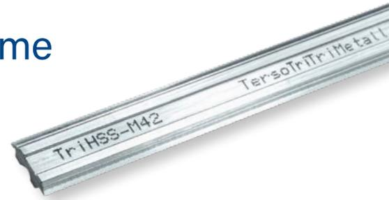
Unsere TersoTri, TriLock, CentoTri, TriPlan, Sinus und Terminus / Tritanius Wendemesser werden in der Trimetall-Technologie hergestellt. Sie bestehen aus drei Teilen (sandwichartig), wobei nur der mittlere Teil weich und flexibel ist. Die beiden Schneiden jedoch bestehen aus hochgehärtetem HSS-M42 Material (24%)\*. Die Schneiden sind mit einem Spiegel-Polierschliff und einem polierten Gegenschliff versehen, was zu einem deutlich besseren Hobelbild und längerer Standzeit führt.
