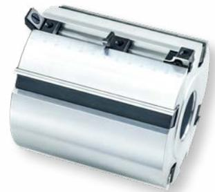
Mit unseren Hobelköpfen können Sie zeitgleich Hobeln, Nuten und Kanten bearbeiten. Das spart Zeit und Kosten. Unsere Multi-Köpfe sind auch bei Tischfräsen einsetzbar, hier jedoch nur mit 2-4 einfachen Wendemessern. Der Messerwechsel gelingt mit Fliehkraft-Spannung (Click-System) denkbar leicht, ohne Einstellhilfen.
