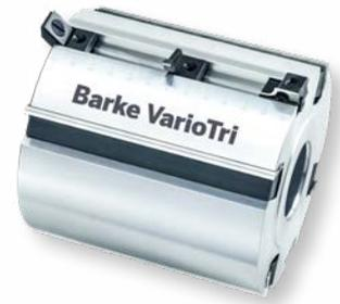
Der BARKE VarioTri ist ein Multi-Kopf für gleichzeitiges Hobeln, Kantenbearbeitung und Nuten. Das spart Zeit und Kosten. Der VarioTri ist auch bei Tischfräsen einsetzbar (nur mit 2 – 4 einfachen BARKE®-Wendemessern). Der Messerwechsel ist denkbar simpel und wird ohne Einstellhilfe erledigt – durch einfaches Einsetzen und Befestigen des BARKE Wendehobelmessers.
